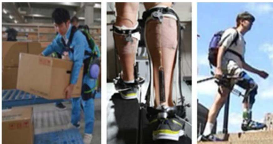
图 5 a) Panasonic suit<sup>[41]</sup>, b) 卡耐基梅隆大学被动踝关节助力装置<sup>[42]</sup>, c) 机械膝关节<sup>[44]</sup>。
